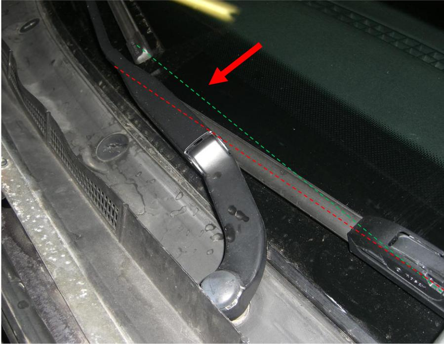
Aufgrund des akut erforderlichen Einsatzes der Scheibenwischer bei Regenwetter wurde der Scheibenwischer bereits durch den Kunden in Eigenregie neu positioniert.
