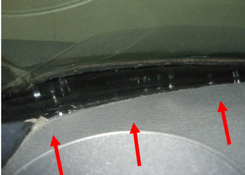
Die umlaufende Dichtung der Scheibe ist in der fahrerseitigen Ecke umgestülpt, liegt unter der Scheibe und ist ggf. in die Kleberaube gelangt.
