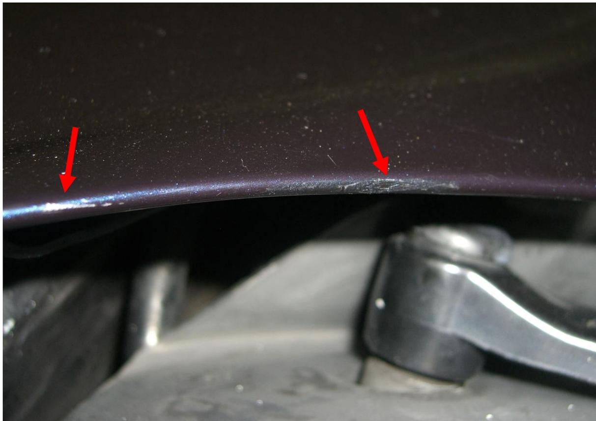
Zu 8) Die Abdeckung des Wasserkastens hat auf gesamter Länge keinen Kontakt zum unteren Windschutzscheibenrand. Dies war zuvor stets der Fall gewesen. Die Position der Abdeckung deutet erneut auf eine falsche Positionierung der Scheibe hin. Die Abdeckung ist zudem sehr lose und klappert. Durch den Spalt dringt Wasser ein.
