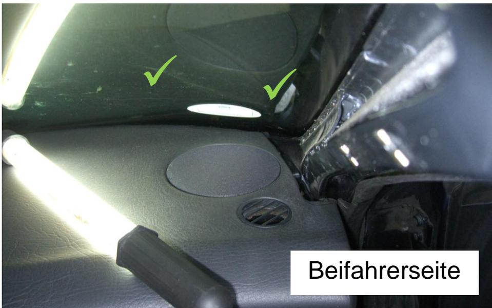
Die Kleberaupe auf der Fahrerseite ist deutlich (trotz des Armaturenbretts und der Verkleidungsteile) sichtbar. Auf der Beifahrerseite hat die Kleberaupe hingegen die richtige Höhe. Die falsche Höhenposition der Scheibe hat zur Folge, dass das Dekor auf der gesamten Länge des Windlaufs schief gegenüber dem Armaturenbrett wirkt. Ferner hat es auf der Fahrzeugaussenseite zur Folge, dass die Chromleiste auf der Fahrerseite den Kotflügel von innen berührt und sogar unter Spannung steht.
