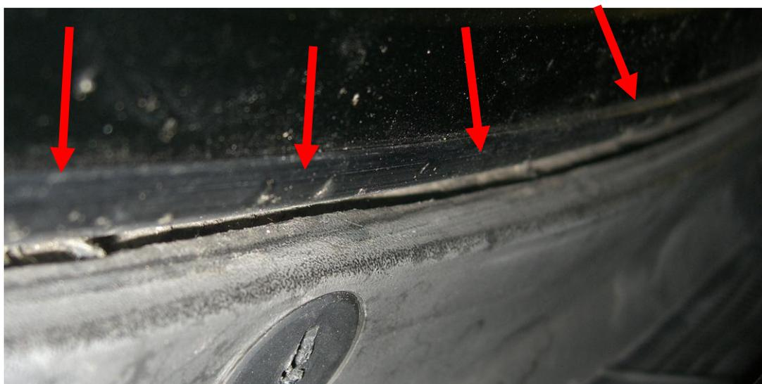
Zu 9) Der fahrerseitige Scheibenwischer ist zu tief montiert. Er berührt den beifahrerseitigen Arm in der Ruhestellung.
