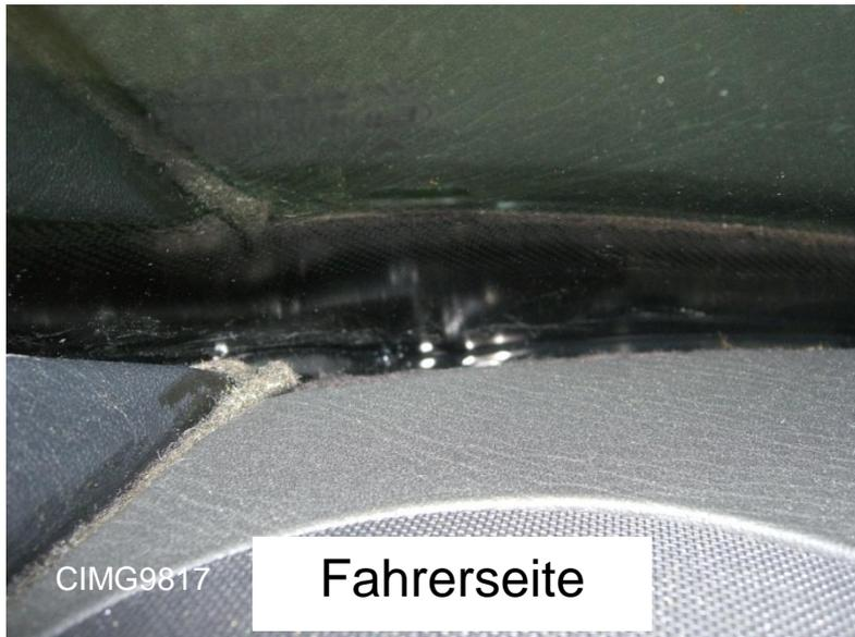
Kleberaube im Bereich Windlauf / A-Säule Fahrerseite **nach erster Reparatur**
